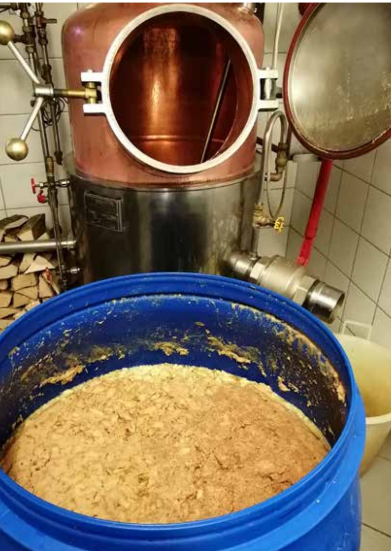
Durch das Erhitzen im Brennkessel gewinnt Schnapsbrenner Franz Hörtnagl aus der Maische das Destillat, das dann in Eichenfässern weiter reifen muss.
